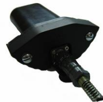
Akku außerhalb des Gerätes laden / Charging battery outside of the instrument
